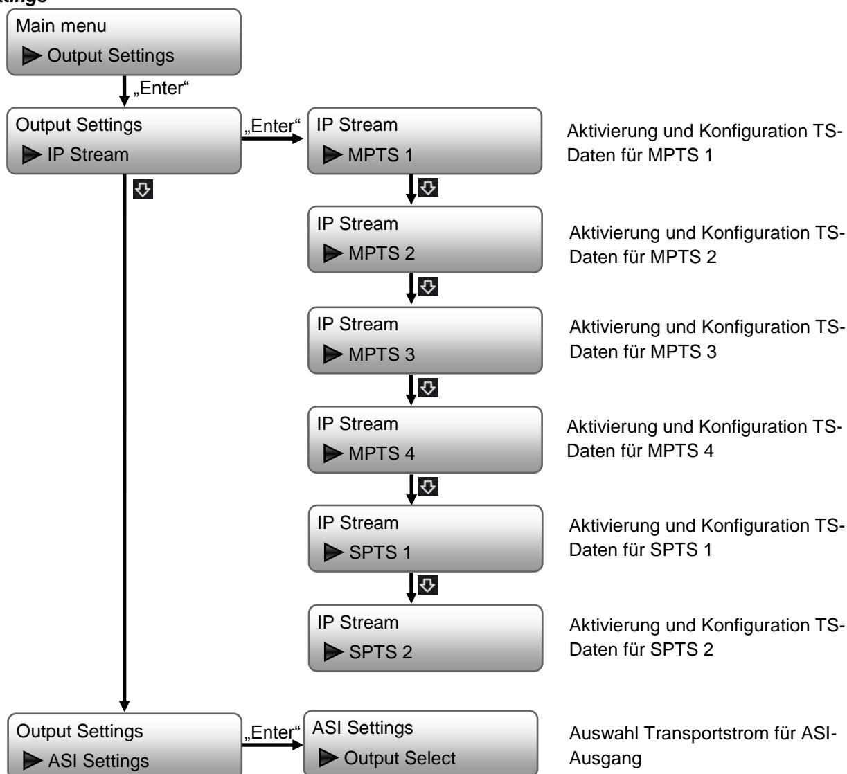
Das Signal des ASI-Ausganges ASI OUT 1 liegt gespiegelt auch am ASI-Ausgang ASI OUT 2 an. Als ASI-Signal können die Transportströme MPTS 1, MPTS 2, MPTS 3, MPTS 4, SPTS 1 oder SPTS 2 ausgewählt werden.
