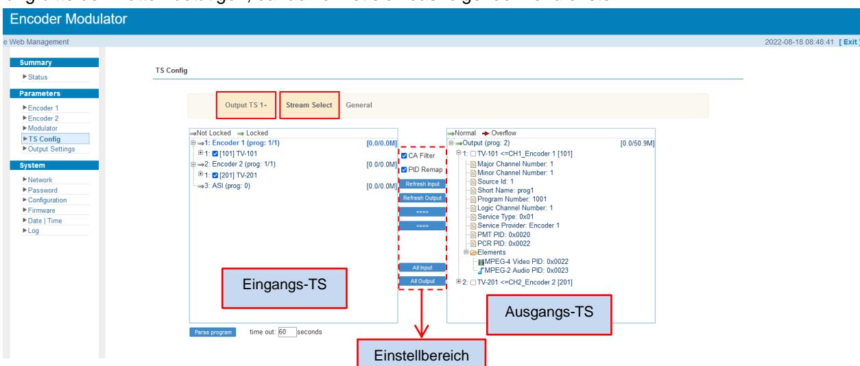
Das Einstellen des „Eingangs- und Ausgangsbereiches“ erfolgt mithilfe der Bedienfelder im „Einstellbereich“.
