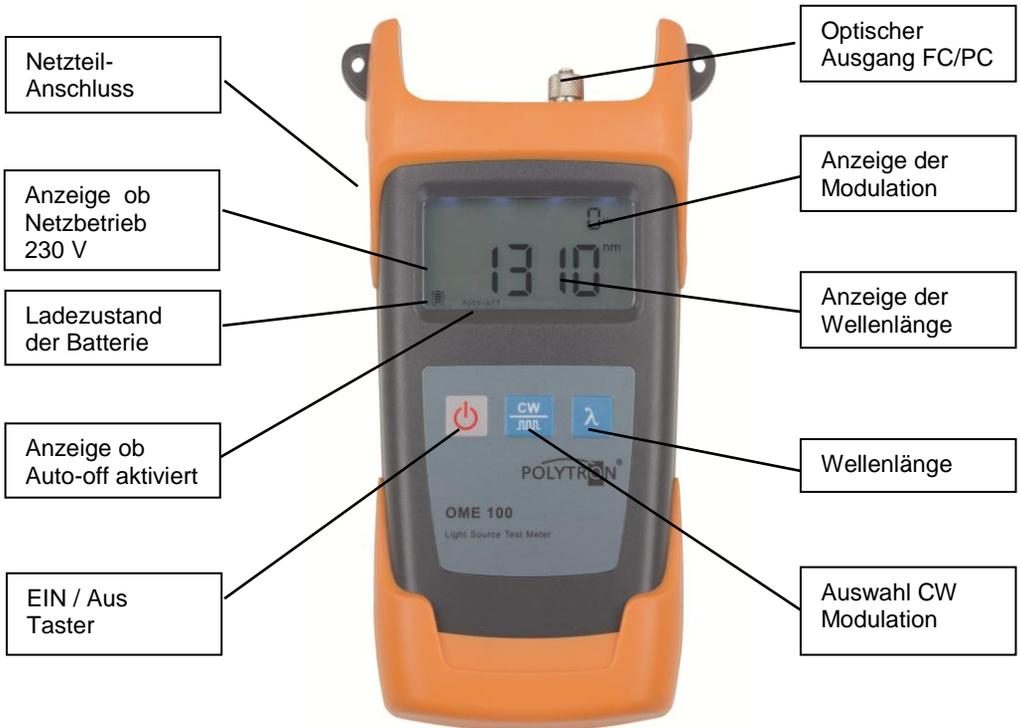
⏻ Ein / Aus – Taster: Dient zum Ein – bzw. Ausschalten des Gerätes. Bei ausgeschaltetem Gerät wird durch einfaches Drücken des Tasters das Gerät eingeschaltet. Ist das Gerät in Betrieb muss der Taster zum Ausschalten ca. 1 Sekunden gehalten werden, Die Auto-Off Funktion ist standardmäßig eingeschaltet, zu erkennen an dem Schriftzug „Auto-off“. Somit schaltet sich das OME100 automatisch nach ca. 10 Minuten aus. Um dies zu deaktivieren genügt ein Tastendruck auf ⏻ .
